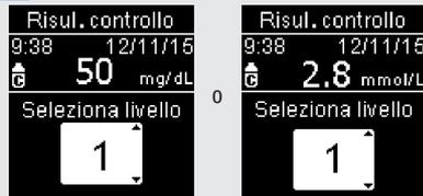
Appaiono **Risul. controllo** e il simbolo del flacone della soluzione di controllo. Premere o per selezionare il livello della soluzione di controllo utilizzata. Se non si seleziona alcun livello, il risultato del controllo sarà salvato senza l'informazione relativa al livello. Premere **OK**.
